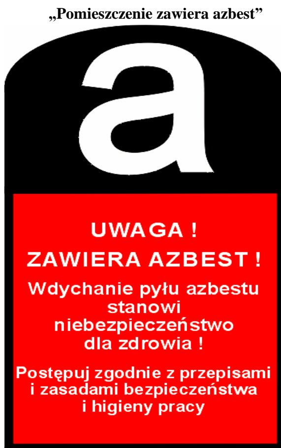
Rys. 16. Wzór oznakowania – pomieszczenie zawiera azbest
